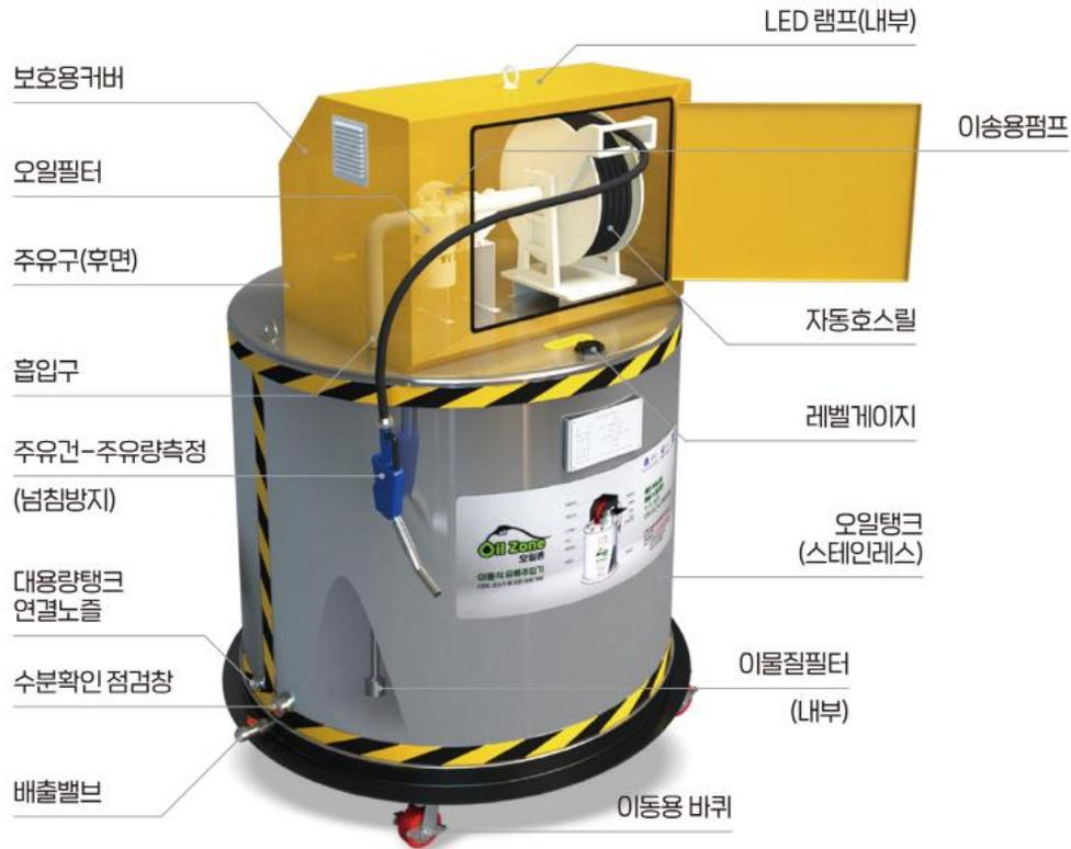
1. 오일탱크(Oil Tank) : 스테인레스(SUS304)로 제작되어 부식방지 및 영구 사용가능.
